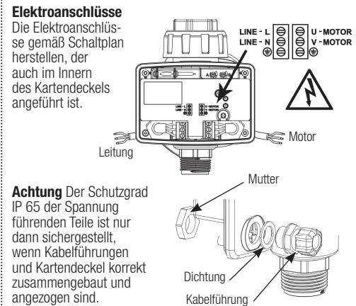
**Achtung** Der Schutzgrad IP 65 der Spannung führenden Teile ist nur dann sichergestellt, wenn Kabelführungen und Kartendeckel korrekt zusammengebaut und angezogen sind.
