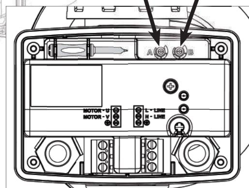
3. der maximal zulässige Strom kontinuierlich 4-16 A (Trimmer B) eingestellt werden,
