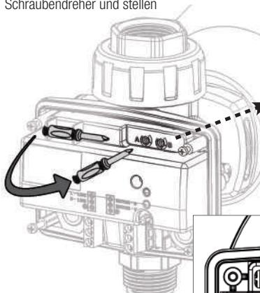
Sie den Trimmer auf den gewünschten Grenzen, je nach den auf der Platte unter dem Schraubenzieher entfernt gezeigten Werte.
