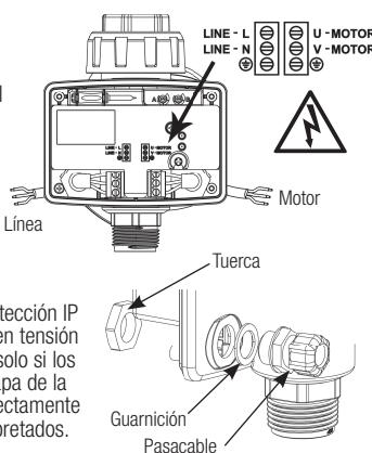
**Atención.** La protección IP 65 de las piezas en tensión está garantizada solo si los pasacables y la tapa de la tarjeta están correctamente ensamblados y apretados.
